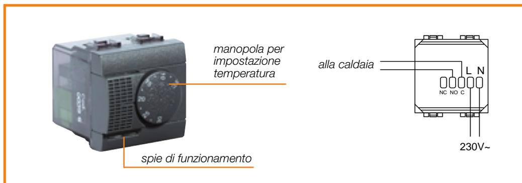
termostato elettronico con uscita a relè mediante un contatto di tipo NO/NC (art. L4441). Questo contatto, libero da tensione, usato nella parte NO (morsetti NO/NC) svolge le stesse funzioni di quello dei termostati a bimetallo: si chiude quando la temperatura va al di sotto del valore impostato sulla manopola frontale dell'apparecchio.
