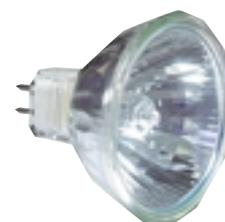
Lampada alogena alimentata in bassissima tensione (12V) con un particolare tipo di diffusore detto dicroico in grado di ridurre sensibilmente il calore indirizzato sull'oggetto illuminato.
