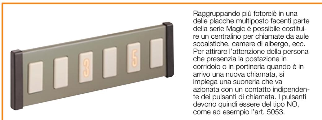
Raggruppando più fotorelé in una delle placche multiposto facenti parte della serie Magic è possibile costituire un centralino per chiamate da aule scolastiche, camere di albergo, ecc. Per attirare l'attenzione della persona che presenzia la postazione in corridoio o in portineria quando è in arrivo una nuova chiamata, si impiega una suoneria che va azionata con un contatto indipendente dei pulsanti di chiamata. I pulsanti devono quindi essere del tipo NO, come ad esempio l'art. 5053.
